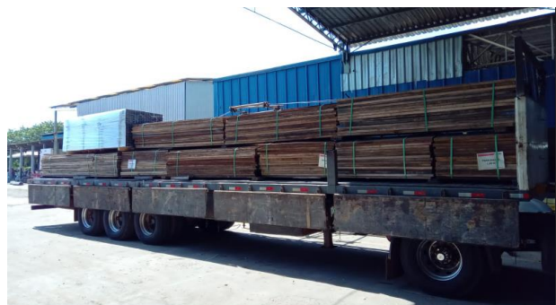
Acomodação de feixes de andaime tubular e piso
